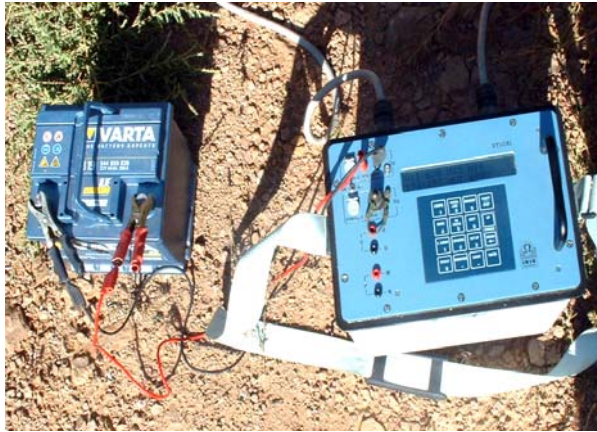
Fig. 8 Detalle del resistivímetro modelo SYSCAL Jr. (derecha) y de la batería (izquierda).
