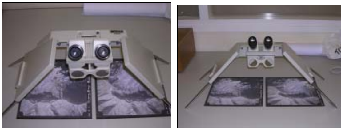
Foto 43 y 44: Estas dos fotografías nos muestran el estereoscopio y la manera como se colocan debajo de el las fotografías aéreas.
