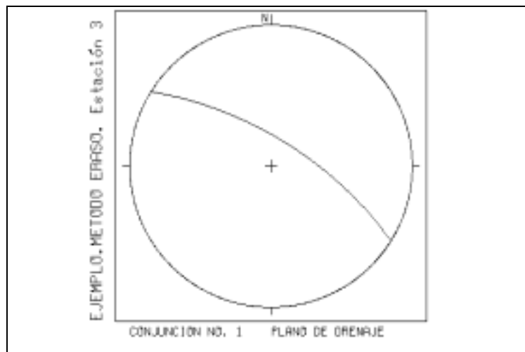
Fig. 49: Representación del plano de drenaje que determina la conjunción anterior obtenida en las salidas gráficas del programa GEODRE
