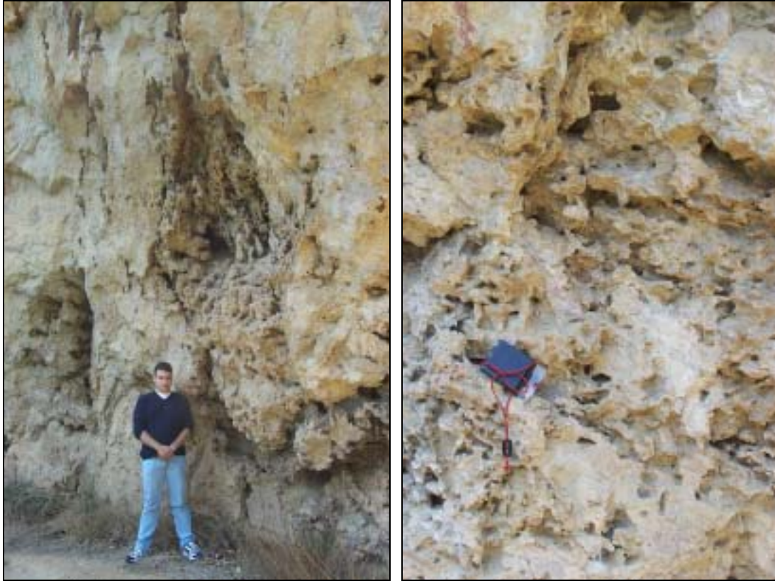
Foto 36 y 37: Estas dos fotografías son un claro ejemplo del tipo de terreno que nos encontramos en esta estación. Como se aprecia en ellas, el terreno está totalmente carstificado, lo que hace imposible el poder medir algún plano.
