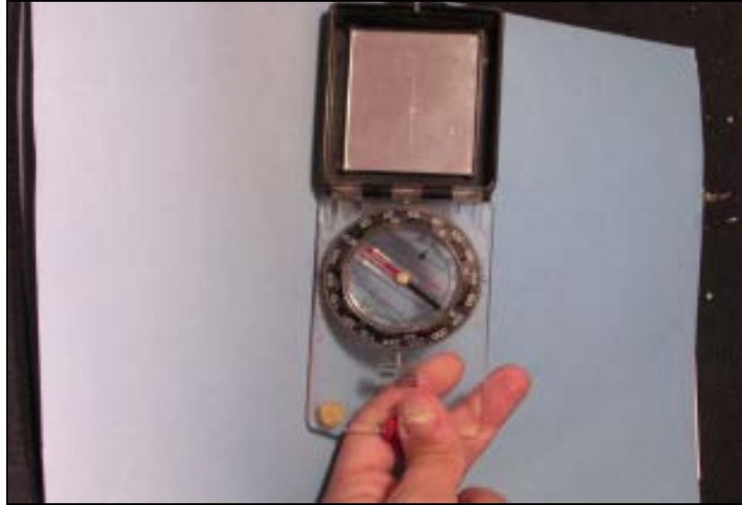
Foto 27: Esta foto nos muestra como se coloca la brújula en un plano inclinado. Giramos la corona exterior hasta hacer coincidir la flecha roja con el norte magnético.
