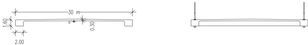
Figura 4: Secció llosa nervada tipus i secció coincident amb tirants. (Font: Elaboració pròpia).
