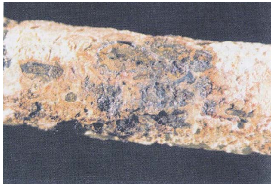
Foto 6: Fil galvanitzat sota els efectes de la corrosió (Font: [3]).
