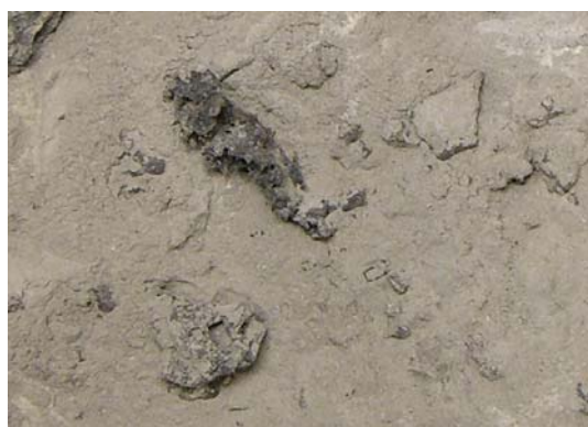
Figura 3.- Aspecto de la escoria blanca, con impurezas de hierro y escoria negra
