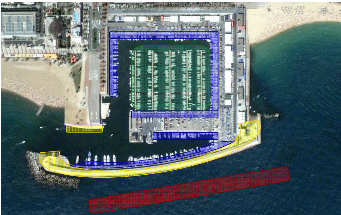
Fig. 1: Planta del port de Olímpic de Barcelona indicant les parts bàsiques d'aquest. En vermell està marcat el dic submergit d'escullera; en groc el dic vertical i contradic; en blau els molls de formigó, alguns amb pantalans flotants; i en verd els pantalans de lloses de formigó pretesat. [Modificada de Solís, J. (2007)]
