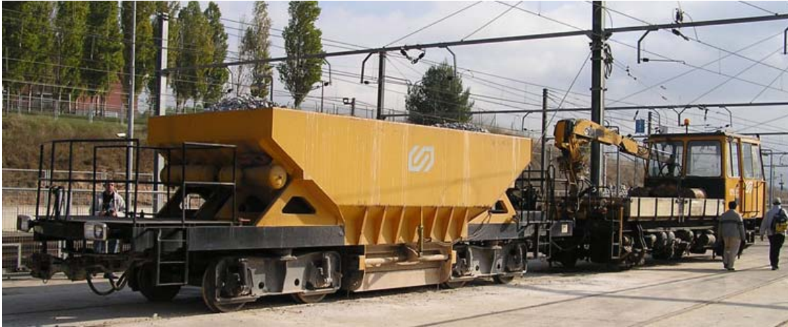
Figura 5.4 Vagó tremuja per al transport de balast (extret de [8])
