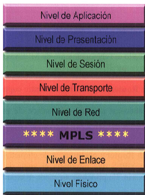
Ilustración 6-1: Posición de MPLS dentro del modelo de referencia OSI
