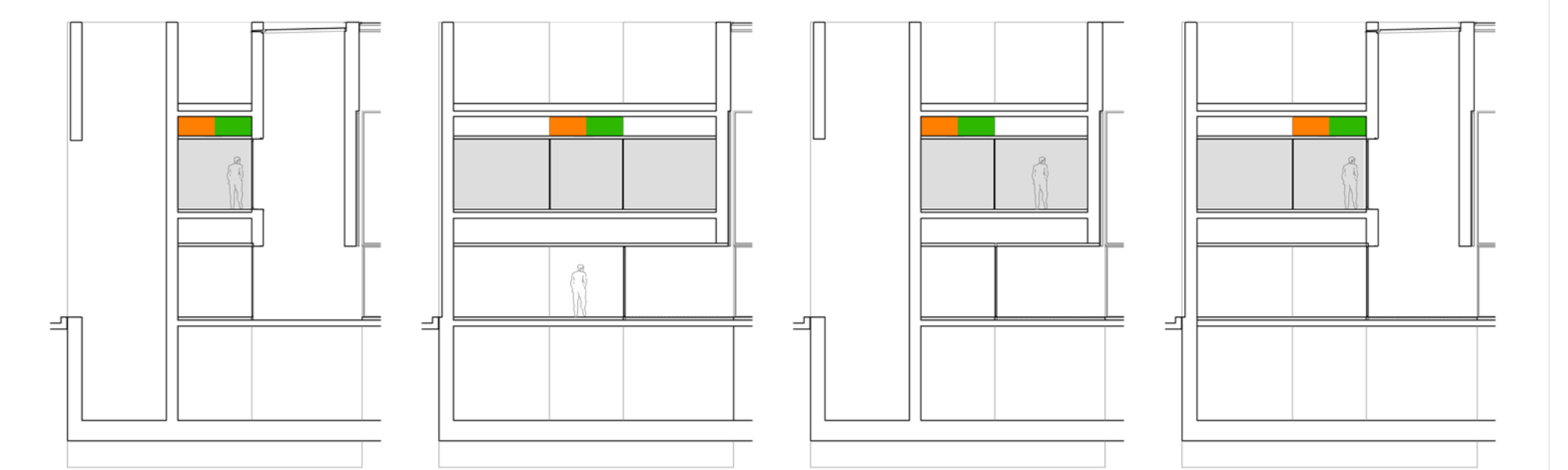
DISTRIBUCIÓ DELS TUBS DE L'AIRE AFRONTANT LES DIFERENTS SECCIÓNS DE LA BANDA OEST
