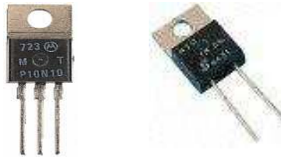
Fig. 2.7 Transistor NPN Darlington TIP121 (izquierda) y resistencia 22\Omega de 20W (derecha). Ambos con encapsulado T0220.
