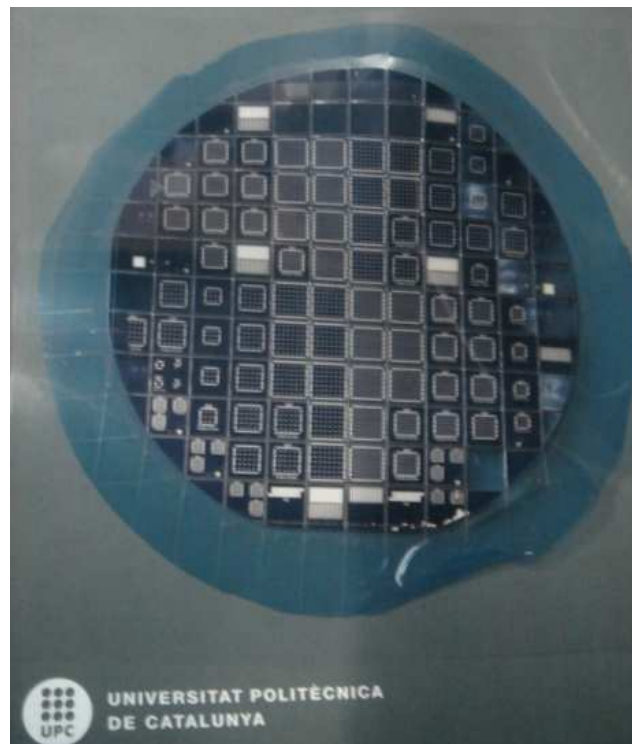
Fig. 1.10 Foto de una oblea de mini paneles solares.
