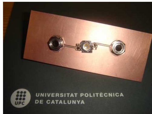
Fig. 2.14 Aspecto final de la placa del LED
