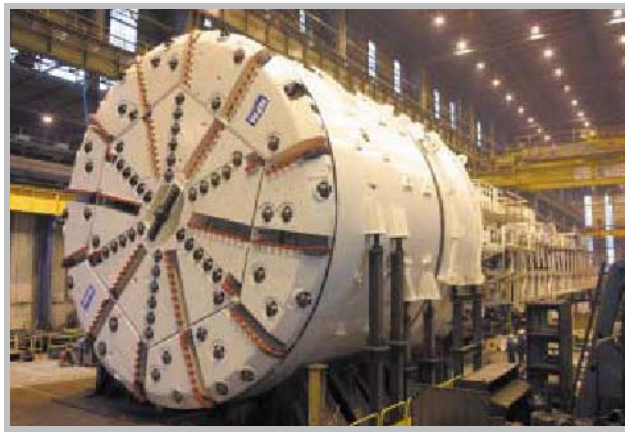
Fotografía 8.- Tuneladora UTE Línea 9
