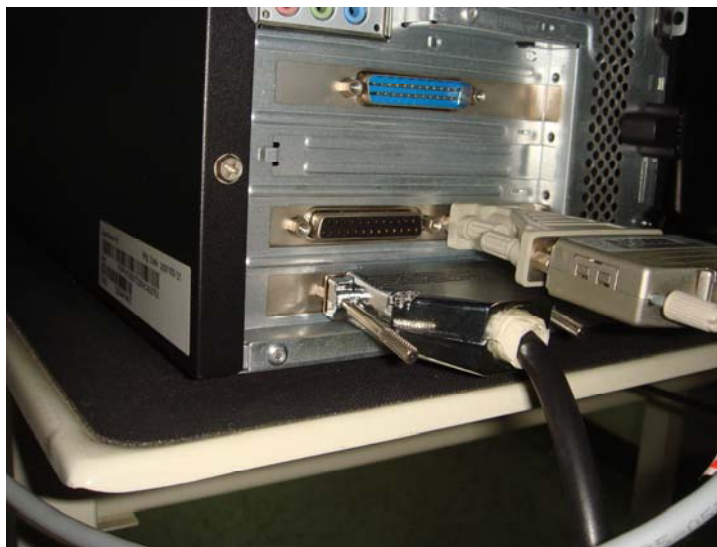
Figura 6.13. Connexions del computador amb les electrovàlvules i el sistema bomba – recol·lector .
