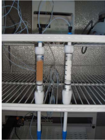
Figura 6.7. Col·locació de les columnes verticalment a la nevera.
