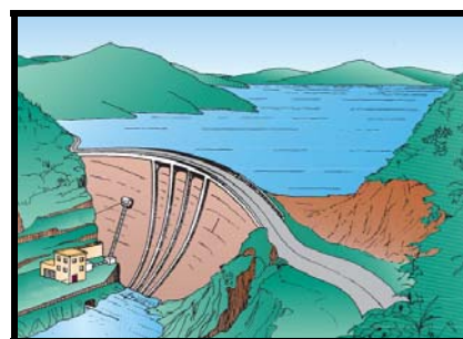
Figura 2: Esquema de una central a pie de presa o caudal retenido
