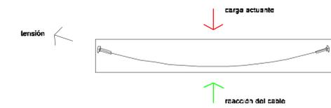
esquema propuesto: estructura postensada
