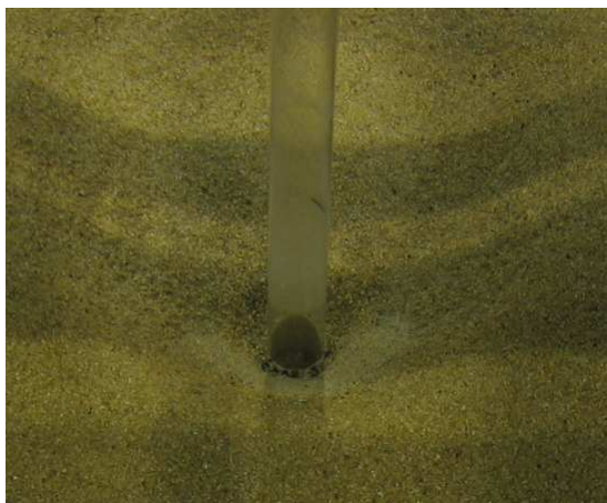
Foto 1. Foso de erosión pila 4.
