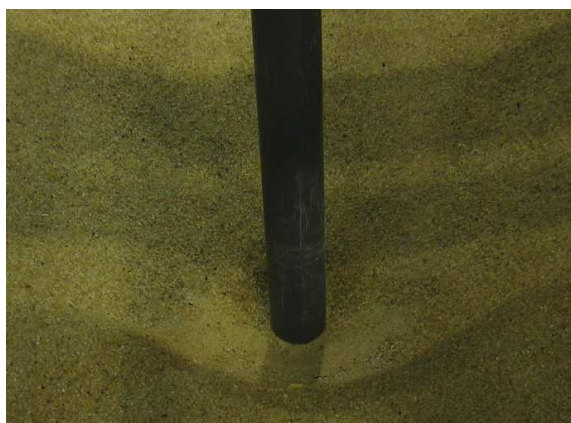
Foto2. Foso de erosión pila 5.
