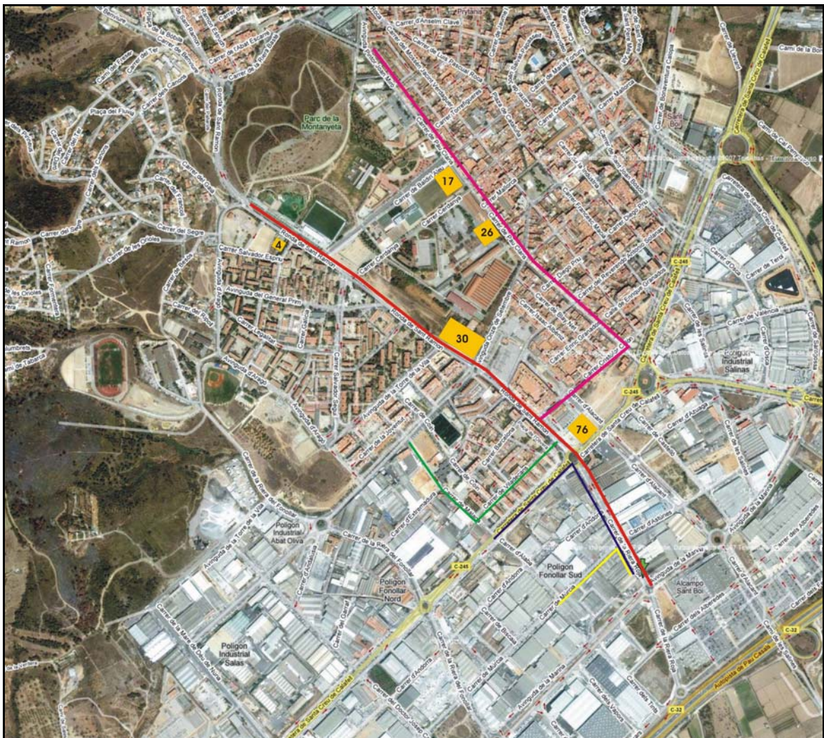
Figura 10. Esquema de la red de drenaje de Sant Boi. Cinco depósitos de retención (17, 26, 30, 76 y 4). Ejes principales Sant Ramon – Riera Roja (rojo), Pau Clarís – Balmes – Colón (rosa) y ejes secundarios Viladecans (verde), Calafell (azul) y Asturias (amarillo).
