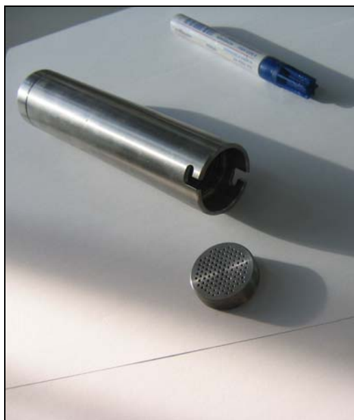
Fig. 6.3 – Vista interior de l'extractor de la planta pilot
