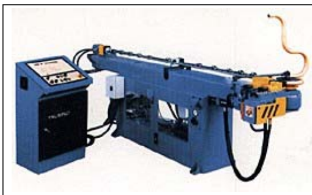
Fig.5.7. Curvadora hidráulica CN
