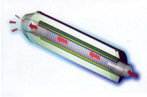
Fig.2.10. Tubo interno salida
