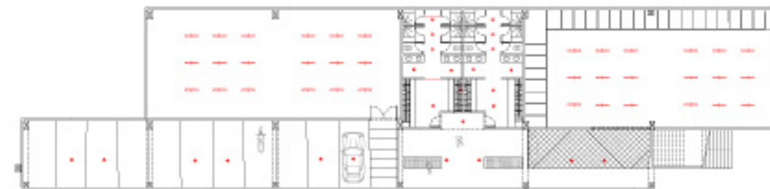
Iluminación Edificio Almacén PB.
