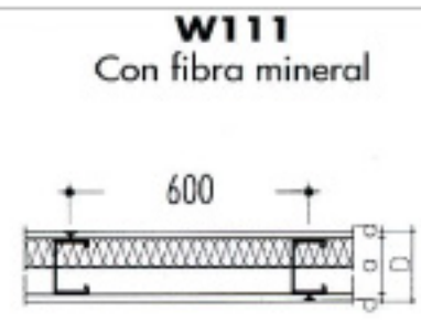
Revestimiento interior con placas de yeso Knauf. Revestimiento exterior con placa de cemento con malla de fibra de vidrio Knauf o similar.
