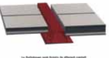
ENCOLAMENT DE LES PLAQUES ALVEOLARS FORMANT FORJATS DE DIFERENT CANTELL
