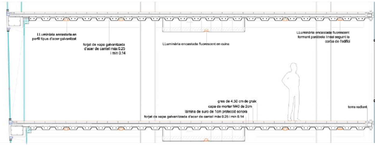
LLuminària fluorescent (l=1,40 m) Fixada en suport metàl·lic soldat a perfil metàl·lic IPN solera metàl·lica soldada de 5cm de gruix
