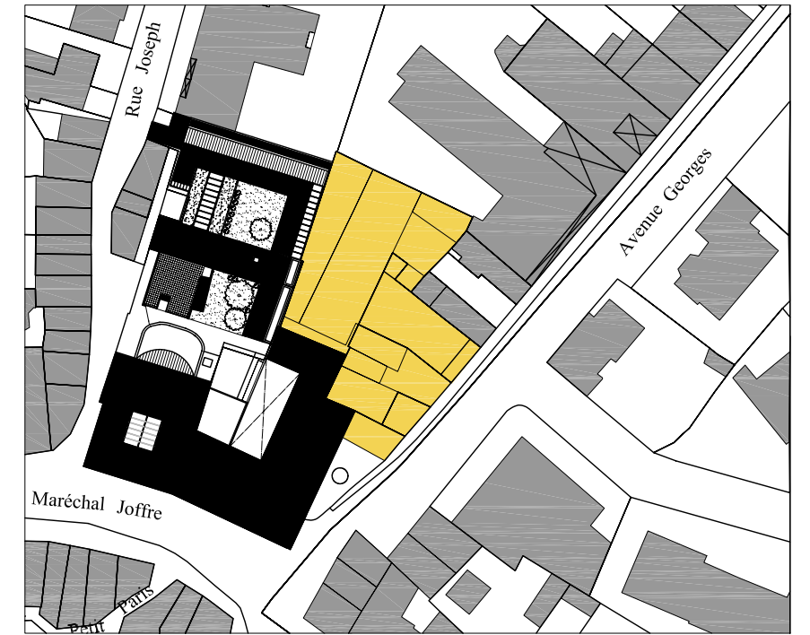
SOLARS UTILITZATS PER L'AMPLIACIÓ EDIFICACIÓ A ENDERROCAR
