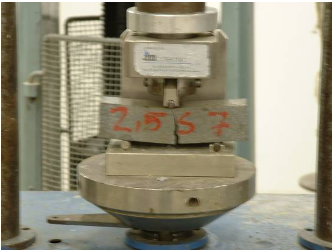
Figura 4. 1: Rotura de una probeta en el ensayo de resistencia a flexotracción.
