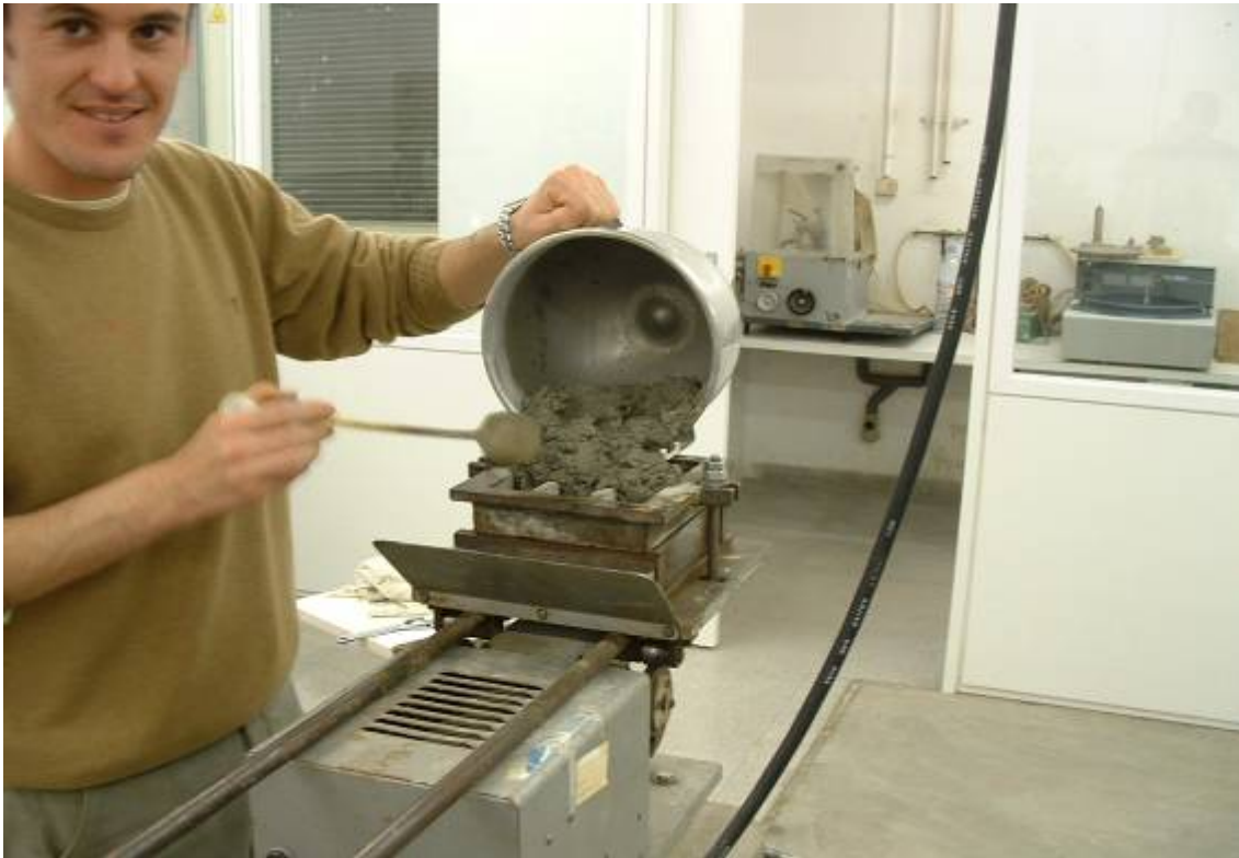
Figura 3. 2: Moldeo y compactación de las probetas.
