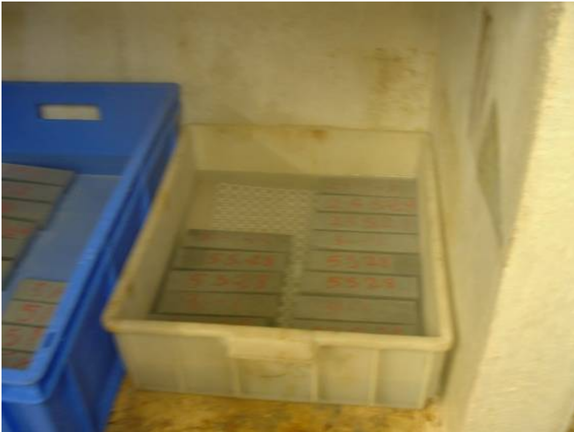
Figura 3. 4: Conservación de las probetas sumergidas en agua.
