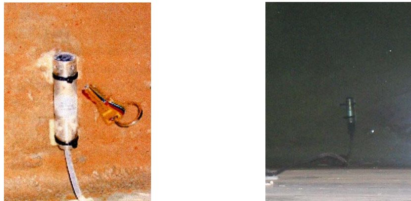
Figura 3.4. Sensores de presión utilizados en el canal CIEM
