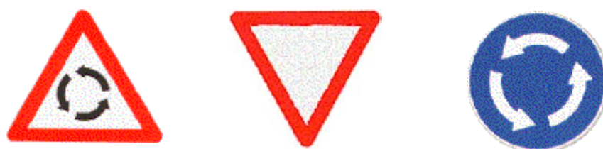
Fig. 2.8: Señales P-4 (Peligro: glorieta), R-1 (ceda el paso) y R-402 (sentido giratorio obligado)
