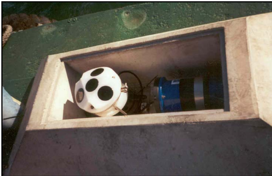
Fig. 2: Correntímetre AWAC junt al seu mòdul de bateries i el bloc de formigó que el protegeix.
