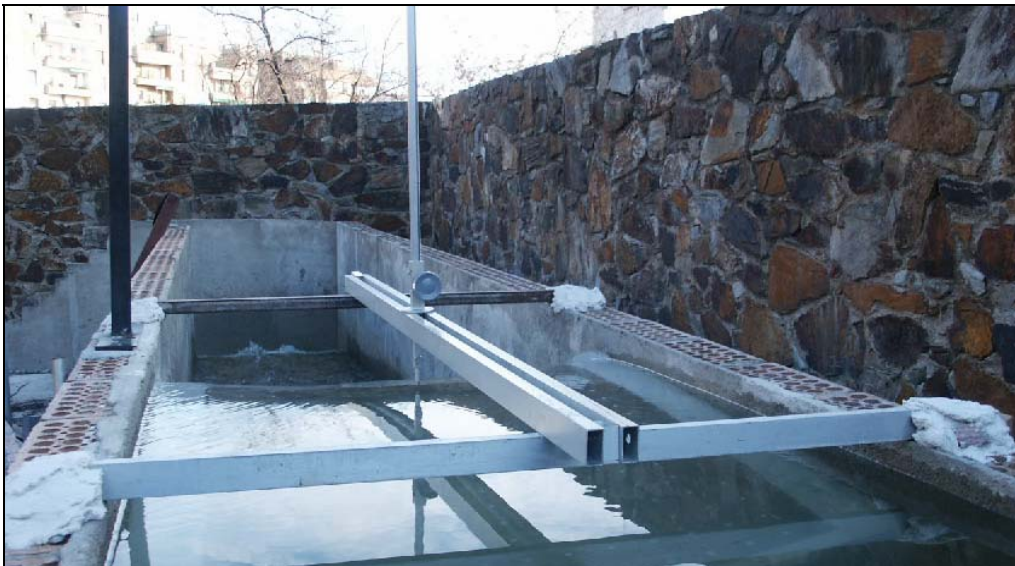
Fotografia 5.2.1. Dispositiu utilitzat per mesurar calats d'aigua.
