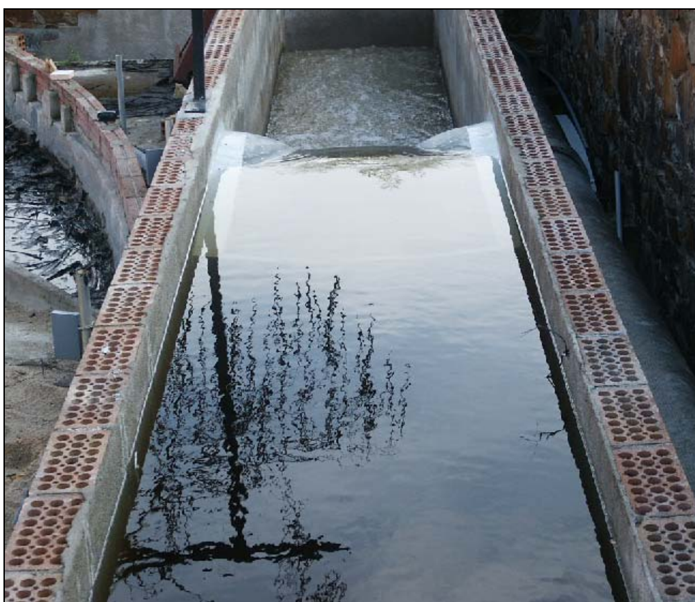
Fotografia A.8. Vista des d'aigües amunt del fluxe per un cabal de 20 l/s.
