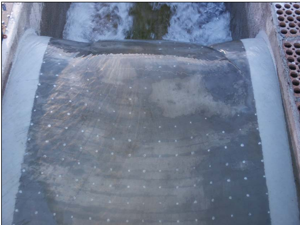
Fotografia A.5. Fluxe d'aigua corresponent a un cabal de 20 l/s.
