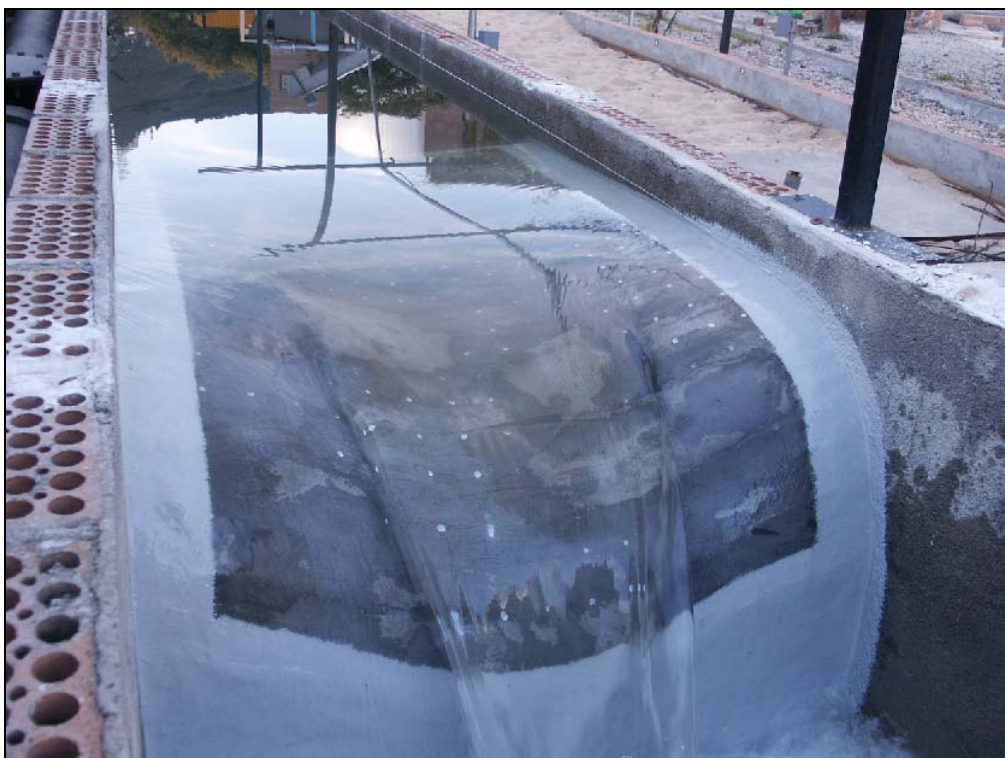
Fotografia A.7. Perspectiva del fluxe corresponent a un cabal de 40 l/s.
