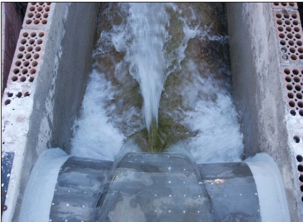
Fotografia A.3. Caiguda d'aigua per un cabal de 40 l/s.
