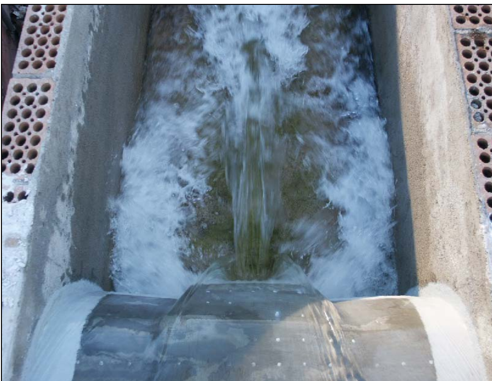
Fotografia A.4. Caiguda d'aigua per un cabal de 60 l/s.
