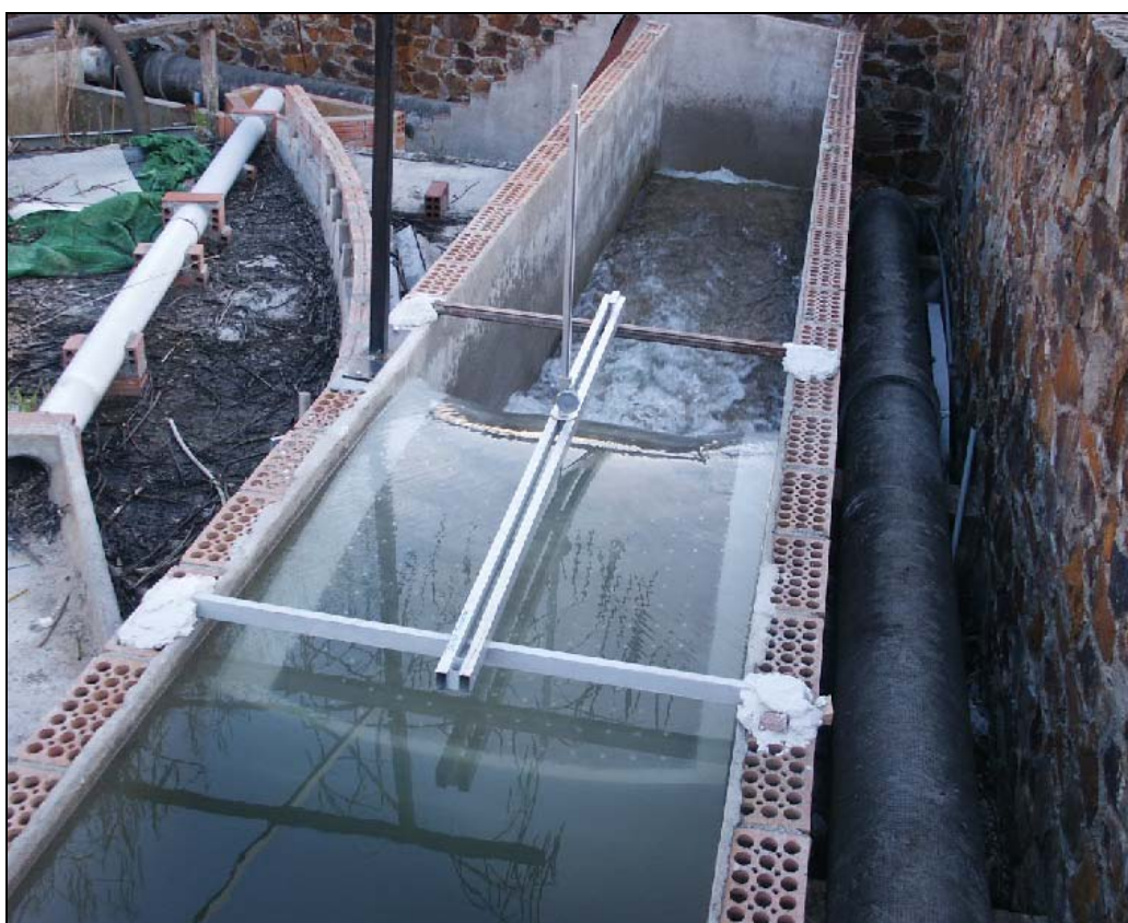
Fotografia A.6. Perspectiva del dispositiu de mesura de calats.
