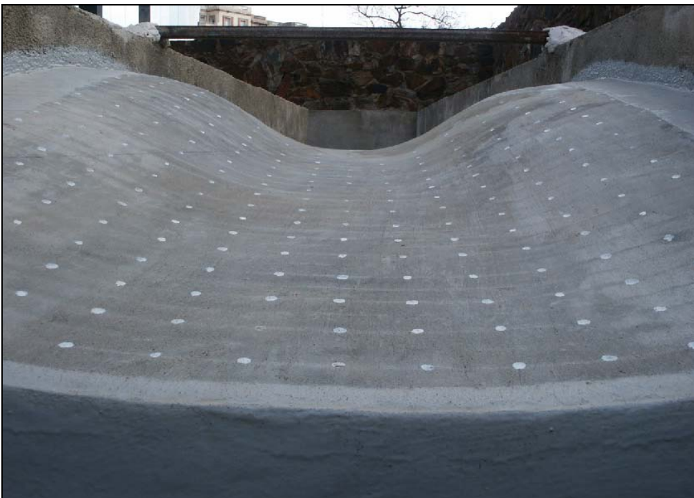
Fotografia A.2. Model a escala instal·lat al canal.
