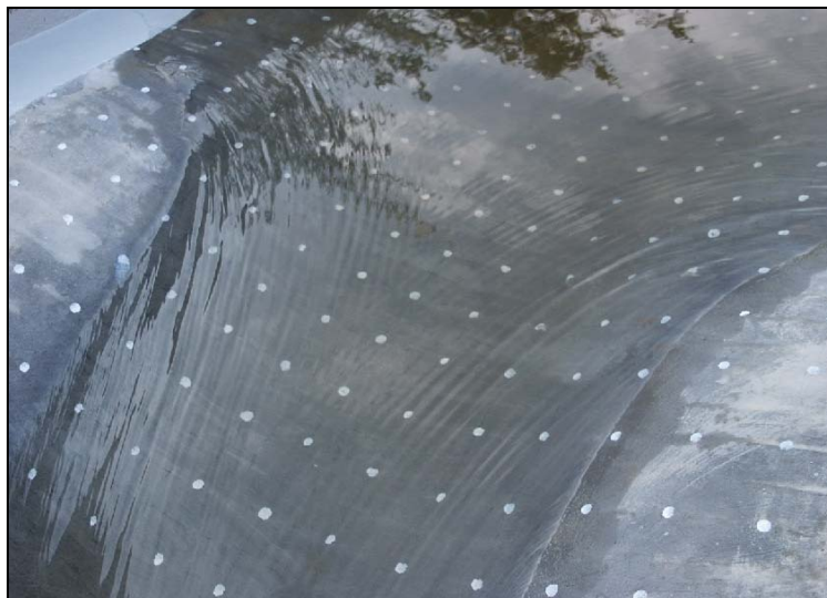
Fotografia 7.2.1. Pèrdua gradual de calat al voltant del règim crític per un cabal de 20 l/s.
