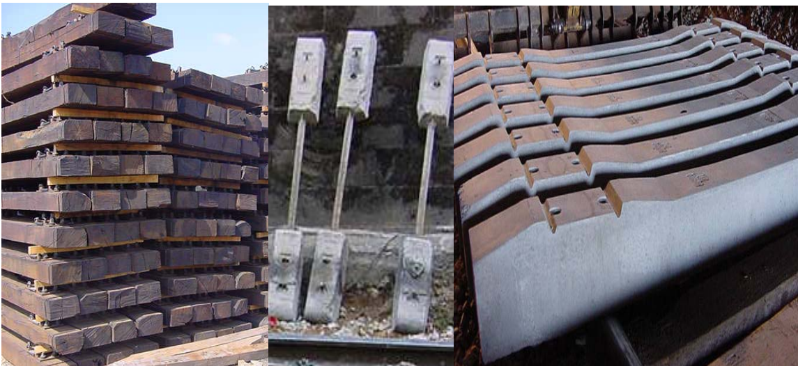
Imagen 1.2, 1.3 y 1.4.- Traviesas de madera, hormigón bibloque y hormigón monobloque.
