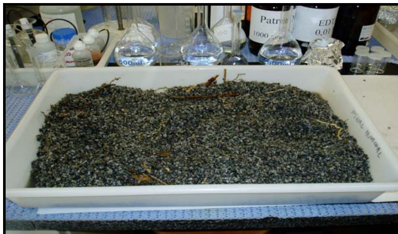
Figura 5.2 Grava estesa en la safata per a muntar els reactors.
