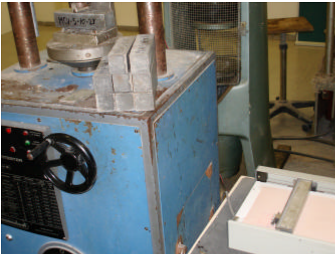
Figura 8. Imagen de la prensa utilizada para el ensayo de flexotracción en morteros (1)
