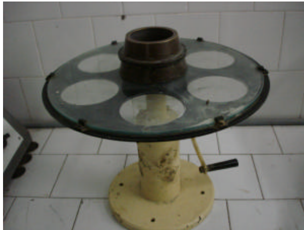
Figura 7. Mesa de sacudidas y molde utilizados para medir la consistencia de los morteros
