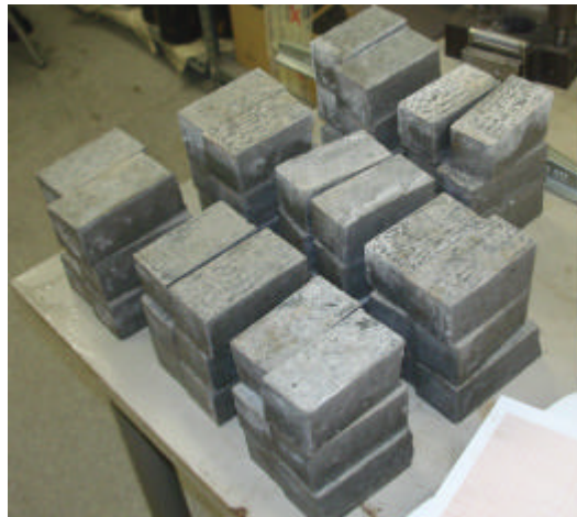
Figura 15. Probetas ensayadas a flexotracción para ser ensayadas a compresión
