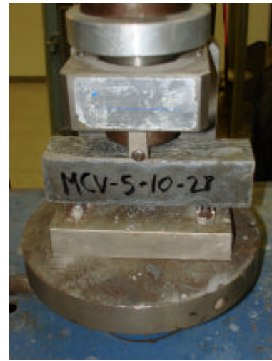
Figura 9. Ensayo de flexotracción en morteros (2)
