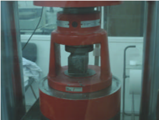
Figura 11. Imagen del ensayo de compresión en morteros
