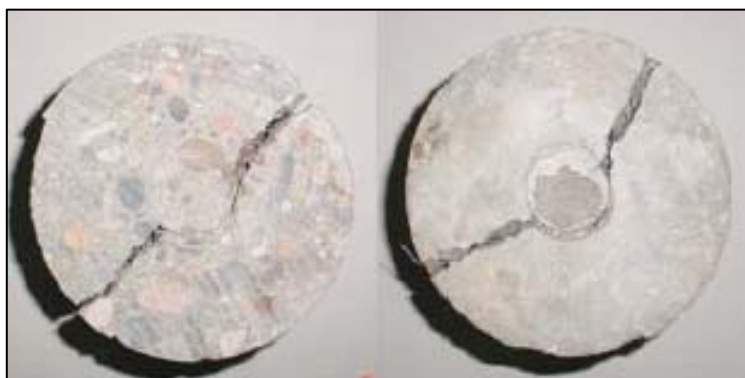
Figura 3.15: Formación de una única fisura diametral (caras superior e inferior de la probeta).
