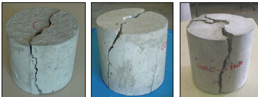
Figura 3.16: Fisuras diametrales en probetas ensayadas mediante el ensayo Barcelona.
