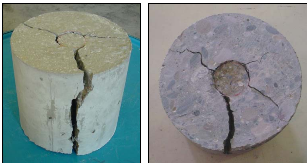
Figura 3.14: Probetas ensayadas mediante el ensayo de doble punzonamiento, en donde se aprecian las formaciones de las diferentes superficies de rotura.
