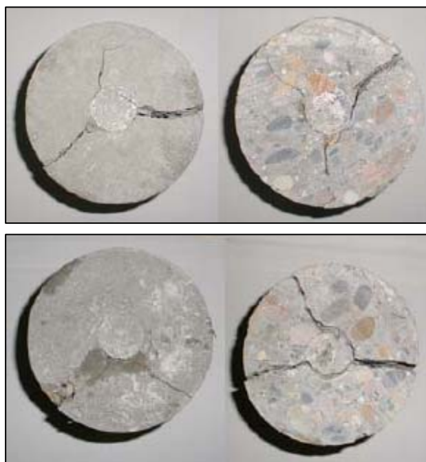
Figura 3.17: Distribución típica de las fisuras radiales que aparecen en dos probetas de HRF ensayadas mediante el ensayo Barcelona.
