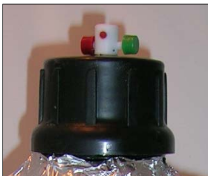
Fig. 3.6 Adaptació de la vàlvula "minert" al nou tap de l'ampolla
