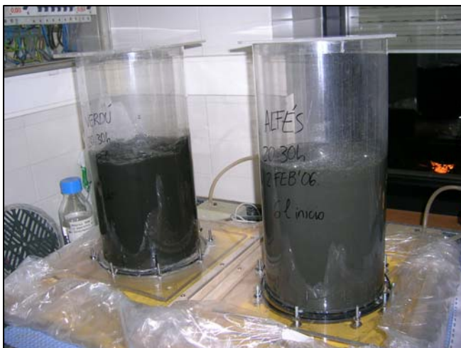
Fig. 3.11 Reactors aeròbics amb l'aigua mostrejada de les EDARs d'Alfés (reactor de la dreta) i Verdú (reactor de l'esquerra)
