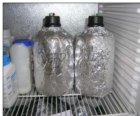
Fig. 3.10 Reactors d'Alfés i Verdú conservats a 20°C per tal d'afavorir l'activitat microbiana
