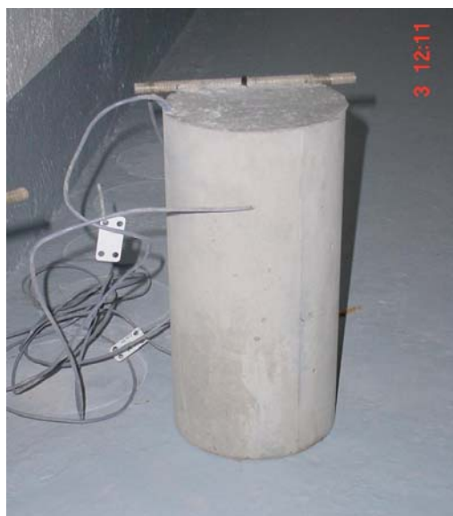
Foto 4.2: Probeta cilíndrica con las galgas
