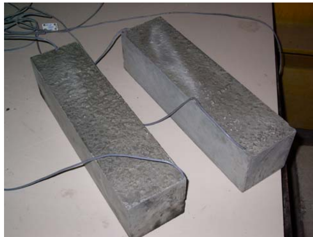
Foto 4.3: Probetas prismáticas con las galgas
