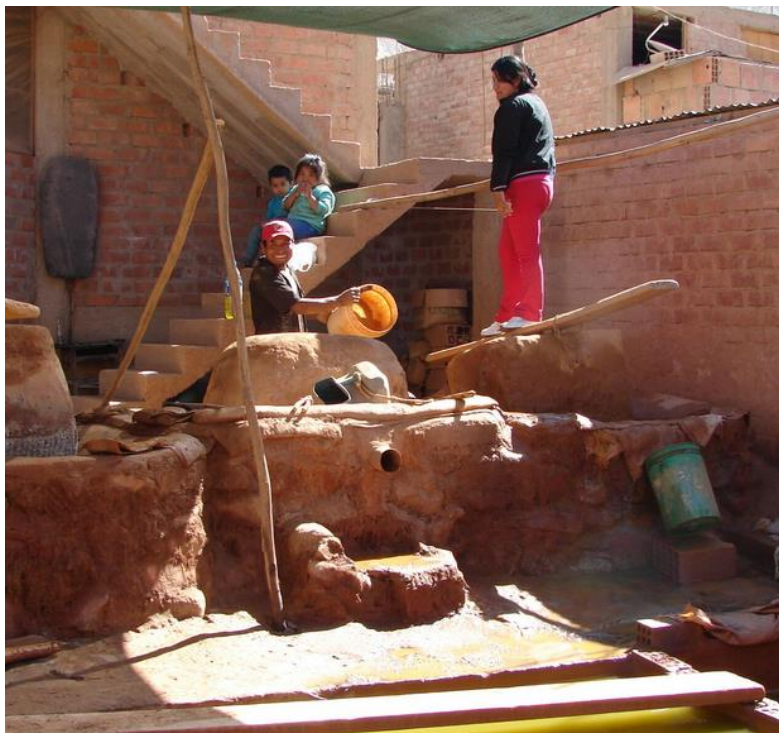
Figura 14. Imatge de la "quimbalete" i la treballadora a sobre amb un altre treballador manejant el contingut amb les mans.
