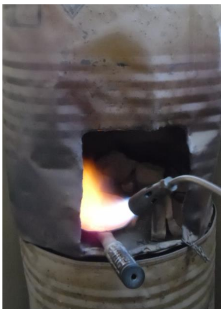
Figura 9. Imatge de "retorta" o crematori on cremen l'ammalgamació per obtenir l'or sense mercuri
