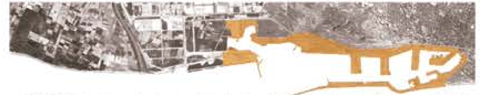
1966-1970 Construcció d'un port interior amb el dragatge de la zona del Delta i augment del recinte portuari en 250 hectàrees.
