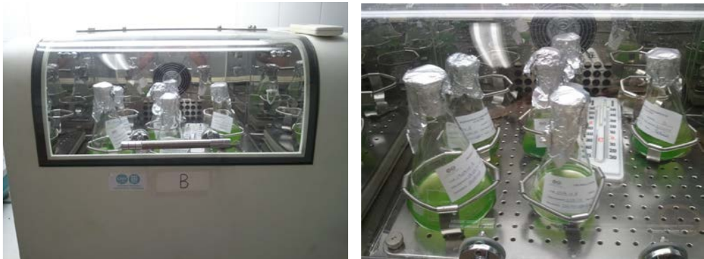
Figura B. 1 A l'esquerra es pot veure la cambra que manté els cultius d'algues en condicions d'esterilitat i en constant agitació per mantenir-les en suspensió. A la dreta, una imatge més dels erlenmeyers amb la solució d'algues i medi i tapats per evitar contaminacions.
