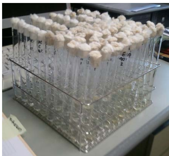
Figura E. 5 Es poden veure els recipients utilitzats i la disposició de l'assaig d'inhibició del creixement de les algues
