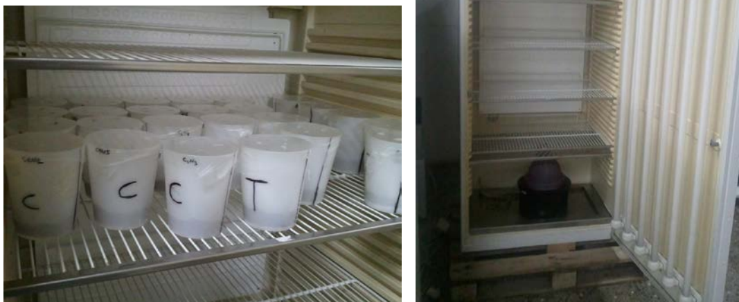
Figura E. 2 A la 'esquerra: gots utilitzats en l'assaig d'allunyament de col·lèmbols. A la dreta: La cambra climatitzada on s'han mantingut les condicions d'assaig
