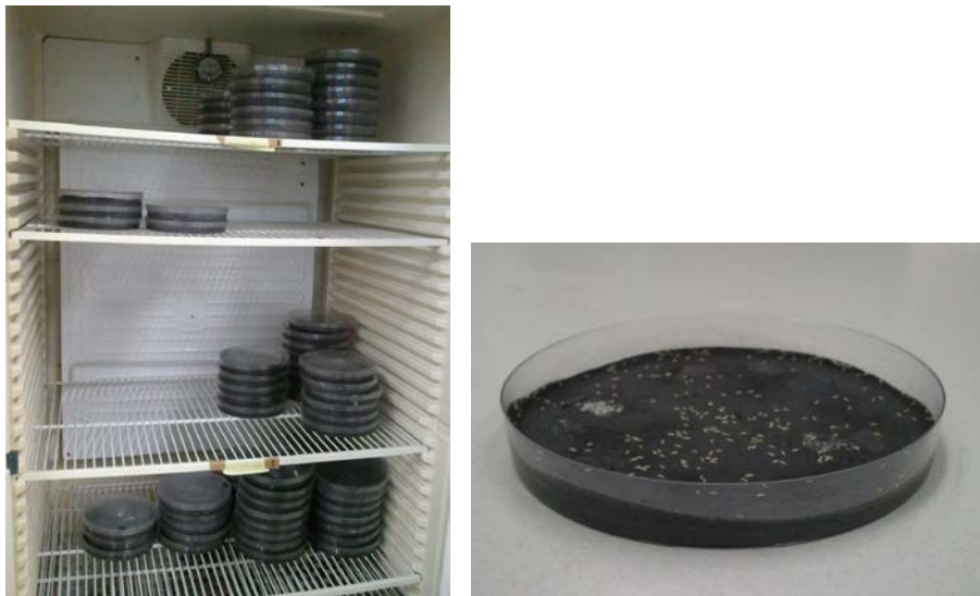
Figura B. 2 A l'esquerra la cambra climatitzada (armari de germinació) on es troben els col·lèmbols classificats per edats i es mantenen a 20^{\circ}\text{C}\pm 2^{\circ}\text{C} i a les fosques. A la dreta s'observa el disc de petri que conté una població d'uns 200 individus de col·lèmbols Folsomia candida sobre un substrat de carboni actiu, guix i aigua destil·lada.
