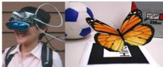
Figura 8: See-through AR. La mariposa es virtual mientras que todo lo demás es real. A la izquierda se muestra la imagen que el usuario ve a través del casco. 16
