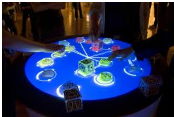
Figura 7: Tabla de música Reactable. Múltiples usuarios simultáneos comparten el control total del instrumento moviendo y rotando objetos físicos sobre la superficie de una mesa circular luminosa. 13
