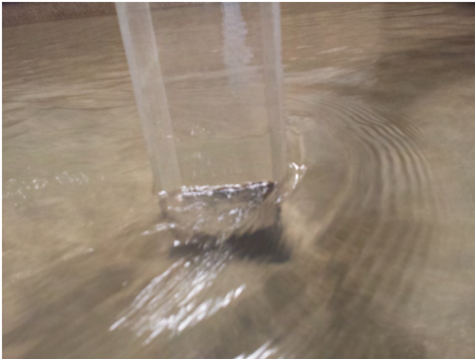
(e) Detalle de la sobreelevación de agua por la pila.
