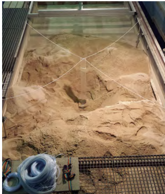
(a) Posicionamiento de la pila en el centro de la zanja.
