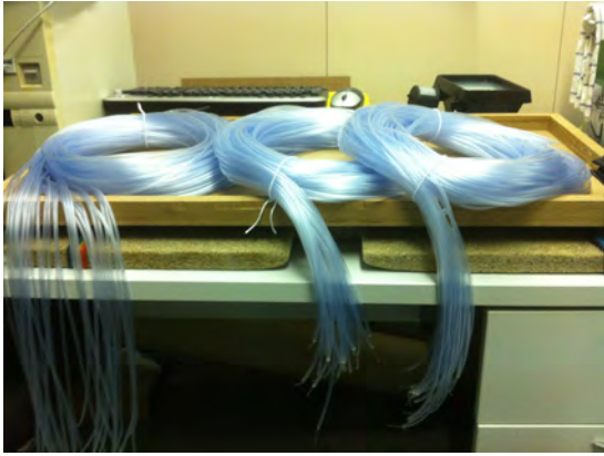
(a) Tubos de plástico para los piezómetros.
