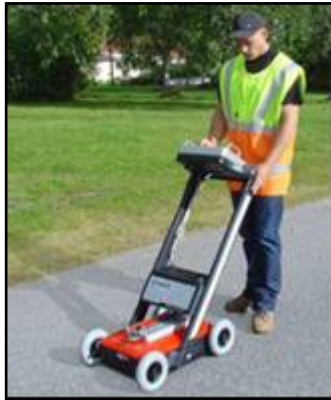
Foto 8: Paso del Georadar - Maquina especializada para la realización de la minizanja (Fuente: Fibra y Sistemas S.L.)
