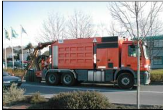
Foto 8: Paso del Georadar - Maquina especializada para la realización de la minizanja (Fuente: Fibra y Sistemas S.L.)
