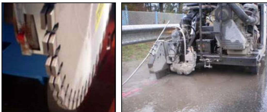
Foto 14: Disco de corte de polvo de diamante - Máquina especializada para microrasa (Fuente: Fibra y Sistemas S.L.)
