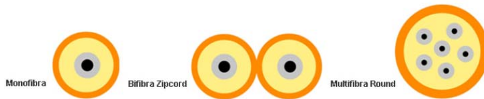
Ilustración 1: Estructura de cables monofibra, bifibra y multifibra (Fuente: www.fibercom.es )
