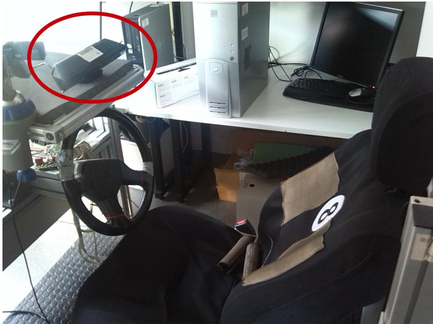
Figura 3: Posición de la cámara Kinect para la medida
