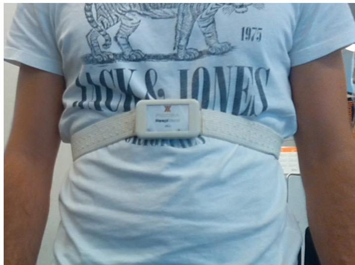
*Figura 1: Banda PLUX colocada alrededor del torax*
