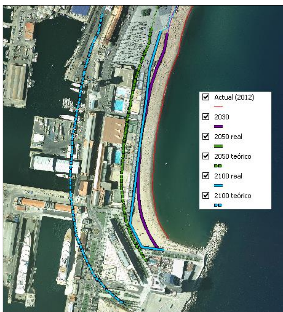
Figura 74. Digitalización de la evolución de la línea de orilla de la Playa de Sant Sebastià Fuente: Elaboración propia (modificada del ICC)
