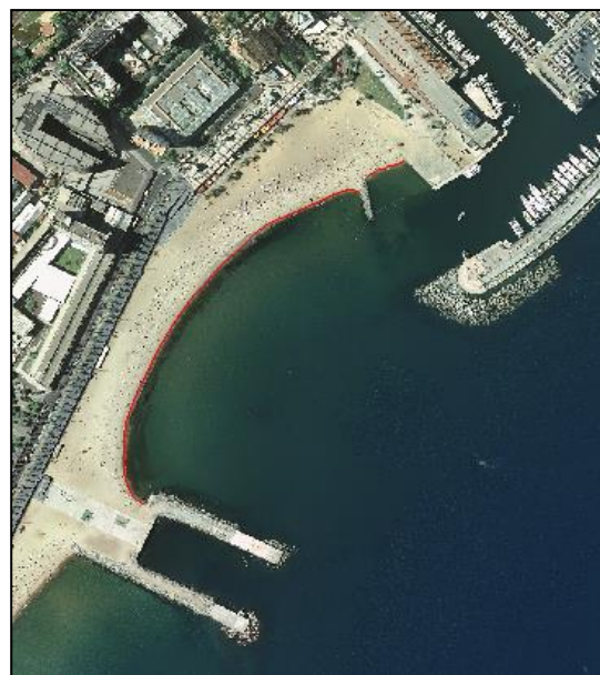
Figura 51. Línea de orilla, playa de Somorrostro Fuente: Elaboración propia (modificada del ICC)
