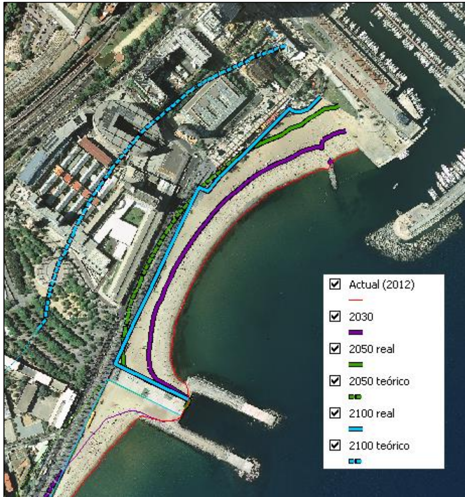
Figura 77. Digitalización de la evolución de la línea de orilla de la playa de Somorrostro Fuente: Elaboración propia (modificada del ICC)
