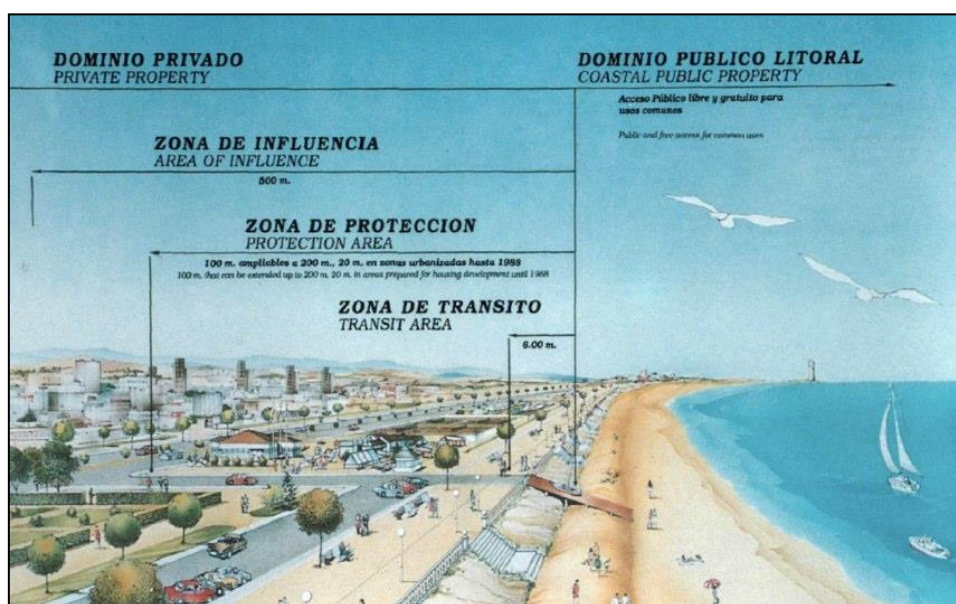
Figura 17. Separación entre áreas de dominio público y propiedad privada Fuente: Portal web http://www.gestion-calidad.com/normativa-agua.html
