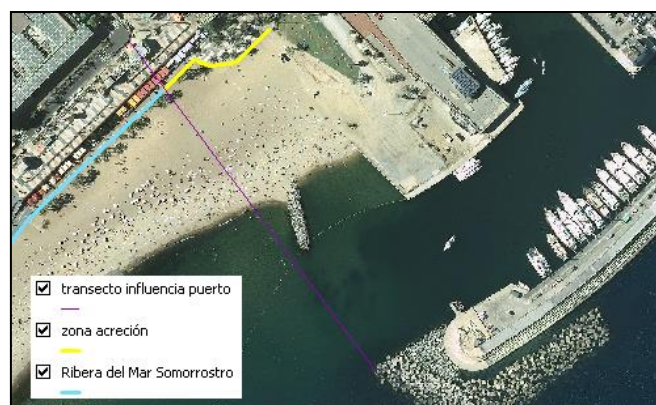
Figura 65. Zona de acreción de la playa de Somorrostro Fuente: Elaboración propia (modificada del ICC)
