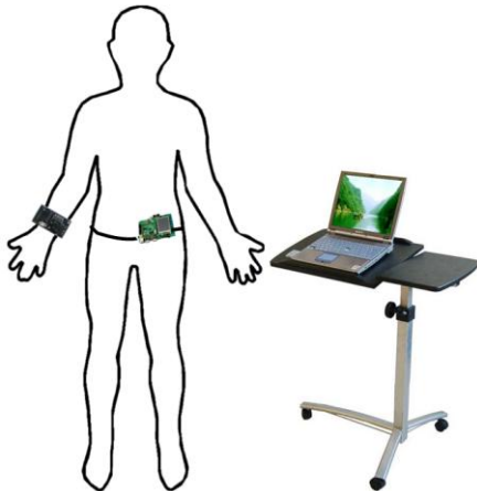
Figura 4 - Ubicación de los sensores y ordenador en el proyecto REMPARK
