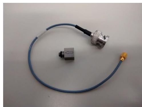
Figura 2. Acelerómetro 4508-B003 compatible con TEDS.
