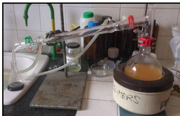
Figura 2.3. Destil·lació simple de les pells de taronja
