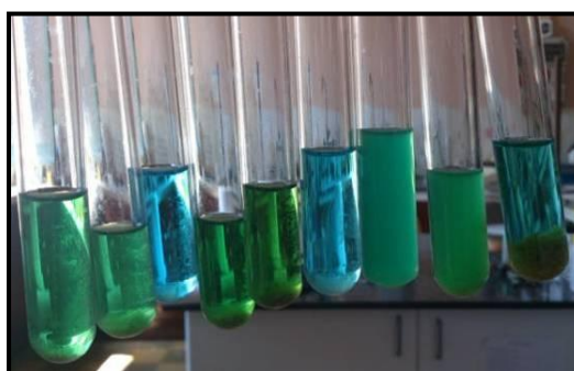
Figura 2.5. Identificació de sucres reductors mitjançant l'assaig de Fehling
