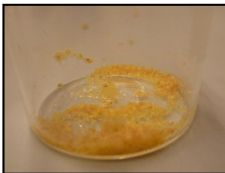
Figura 1.8. Prova d'absorció d'aigua de la pell de taronja mòlta.
