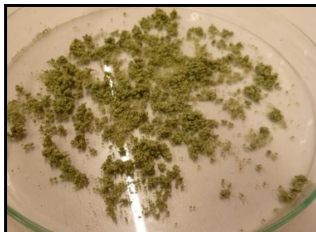
Figura 5.6. Aspecte final de les pells de taronja tractades que han adsorbit coure.
