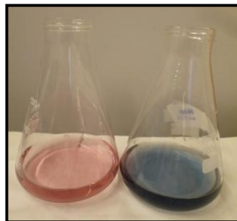
Figura 4.4. Comprovació de l'excés de calci en les pells tractades.
