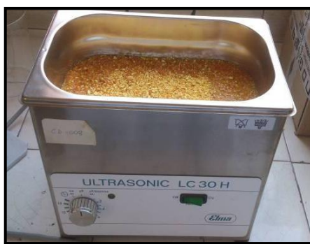
Figura 2.1. Pells de taronja submergides en aigua dins l'aparell d'ultrasons
