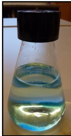
Figura 5.1. Aspecte d'una dissolució de coure (II) (amb sulfat de coure precipitat)
