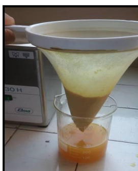
Figura 2.4. Filtració de les pells destil·lades
