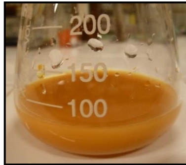
Figura 5.3. Aspecte d'una dissolució 1000ppm de Cu (II) quan se li afegeix KI.
