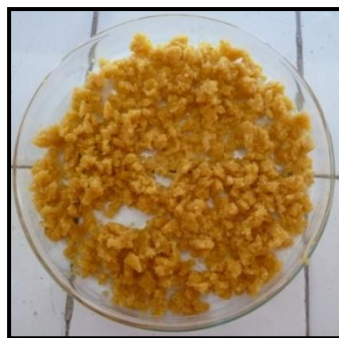
Figura 3.4. Aspecte de les pells de taronja saponificades abans de l'asseccament tèrmic.
