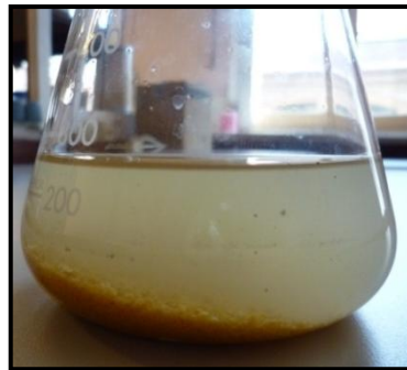
Figura 4.3. Aspecte de la dissolució després del tractament de reticulació.
