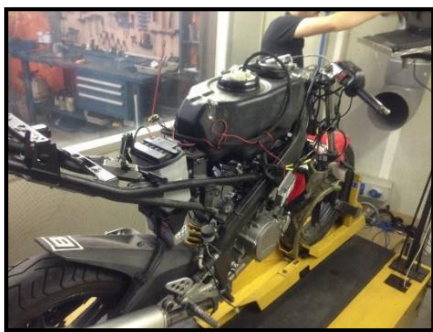
Fotografia 6. Prototip de motocicleta en el banc de potència DYNOJET 250I
